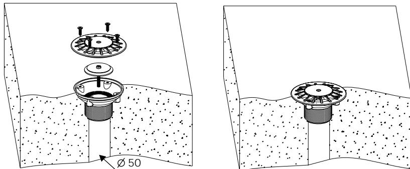
Concrete Pool with Liner Assembly / Montaje Piscina Hormigón con Liner
