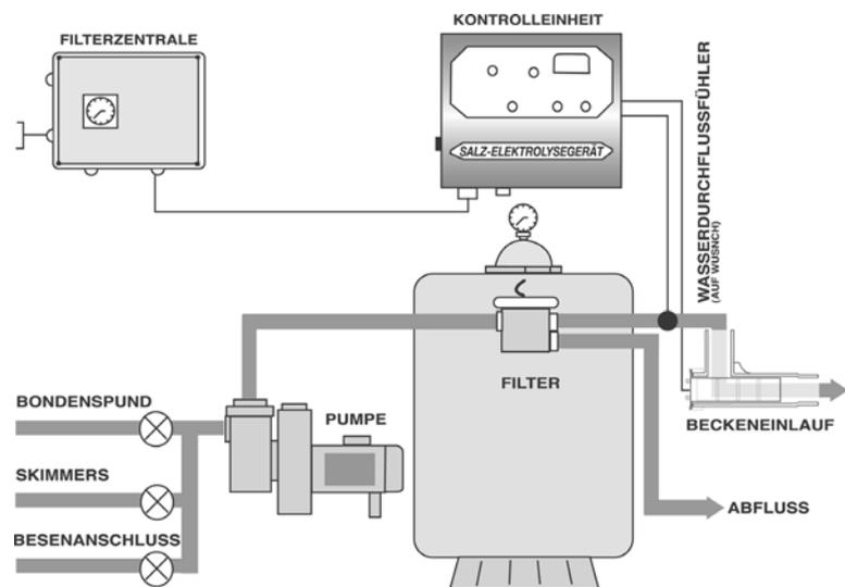
Installieren Sie die Zelle in die Beckeneinlaufleitung (50 oder 63), nach dem Filter und der Vorheizung oder Turboanschluss.
