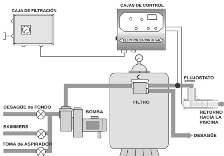
El vaso debe pegarse a la canalización (en 50 o 63) en el retorno hacia la piscina, después del filtro y del recalentador o de la salida del compresor.
