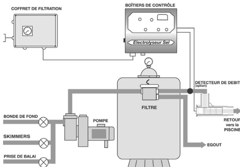
Le vase doit être collé sur la canalisation (en 50 ou 63) sur le retour vers la piscine, après le filtre et après le réchauffeur ou départ du sur-presseur.
