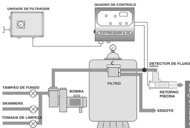
A célula deve ser intercalada na canalização (em 50 ou 63) no retorno para a piscina, depois do filtro e depois do aquecedor ou da saída do compressor.
